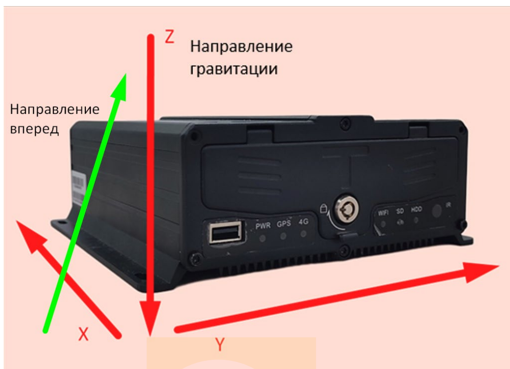
Рисунок 76 – Установка регистратора, когда его оси различно ориентированы с направлением движения ТС
