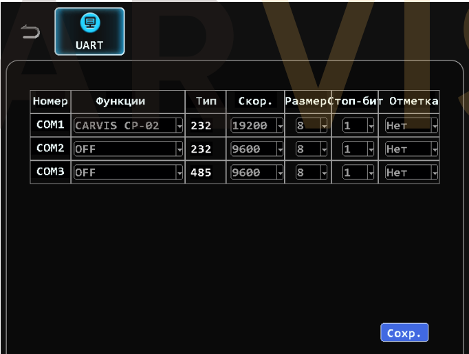
Рисунок 99 – Настройки во вкладке «UART» при подключении CARVIS CP-02 на примере CARVIS MDA-498HDD lite
