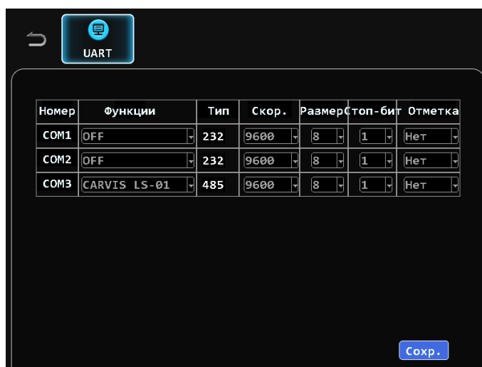
Рисунок 103 – Настройки во вкладке «UART» при подключении CARVIS LS-01 на примере CARVIS MDA-498HDD Lite
